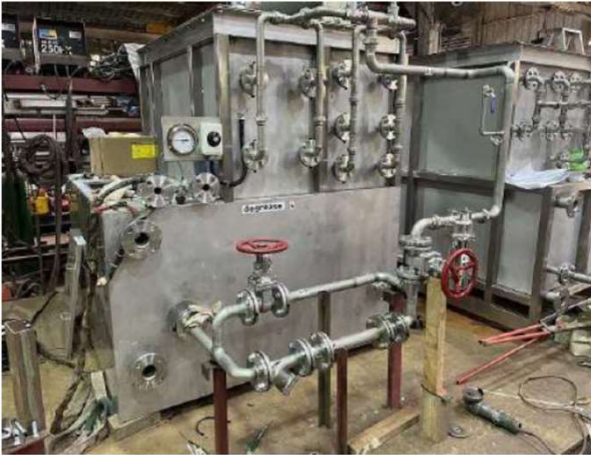
脱脂槽、水洗槽と写っていない湯洗槽の更新です。エバラ製ポンプは国内手配の為、ダミーパイプです。
